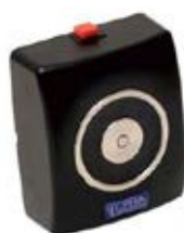
③ retentor eletromagnético com botão de desbloqueio, alimentação: 24 Vdc / 70 mA, estrutura em aço galvanizado e caixa em ABS preto
