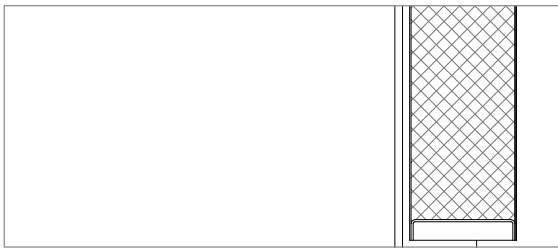
aro esmagado (6) | montagem em parede de alvenaria | fixação com ferros de espera | remates em reboco e gesso | mola oculta
